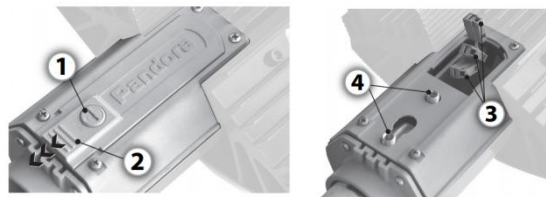
Рисунок 2. Схема установки светильника на кронштейн.
